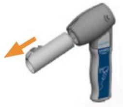
2. Sumergir la turbina en una solución de desinfectante orto-ftaldehído. Aclarar la turbina sumergiéndola en agua destilada. No aclarar la turbina bajo el chorro de agua del grifo, ya que puede dañarla.
